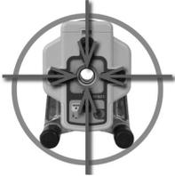
**Automatisches Neigung Messen Z-Achse (Spot-Match):** (analog Grade Match - Messen der Neigung zwischen zwei bekannten Höhenpunkten) – Automatisches Ausrichten des Lotstrahls zur Mitte des SF601 (beide Achsen Z+X) mit anschließender Anzeige des Z-Achsen-Prozentwertes
