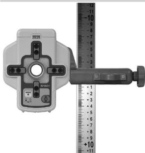
SF601 montiert an einer Messlatte mit der Standard-Empfängerklammer
