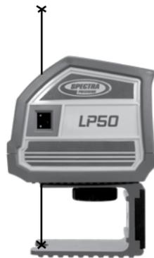
5. Markieren Sie den Punkt des nach oben weisenden Laserstrahls an der Decke (das Doppelte des Istfehlers).
