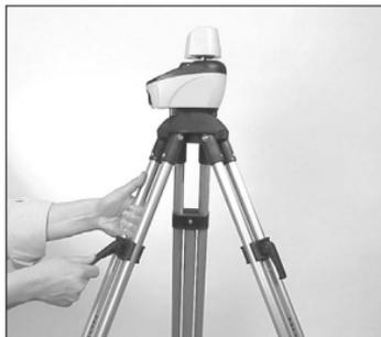
**Hinweis:** Der maximale Arbeitsdurchmesser beträgt 130 m in der Y-Achse und 300 m in der X-Achse. Der Mindestabstand zur Wand von 3 m darf nicht unterschritten werden.
