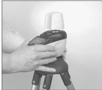
**ACHTUNG:** Drehen Sie den Laser beim Nivellieren nicht um mehr als  $360^\circ$ . Dies kann dazu führen, dass die Zugfeder, mit der der Laser am Stativkopf befestigt ist, beschädigt wird. Wenn sich der Laser nur schwer drehen lässt, drehen Sie ihn zuerst um  $180^\circ$  in die entgegengesetzte Richtung.
