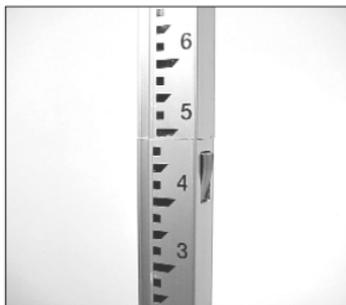
2. Zum Einsatz der Messlatte 0205-2530 sind die Teleskopelemente ganz auszuziehen.
