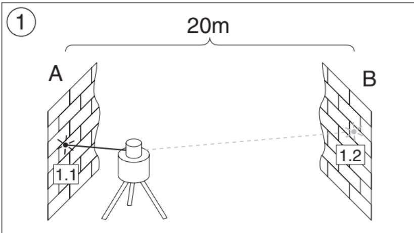
Nu plaatst u het toestel in de buurt van muur B. Richt de laserstraal van het genivelleerde toestel in de richting van de x-as naar muur B, naar de voordien gemaakte hoogte (uit de meting van muur A). Draai het toestel 180°, nivelleer het en markeer het midden van de straal op muur A. Het verschil van de beide hier gemaakte punten geeft nu de werkelijke afwijking van het toestel weer.
