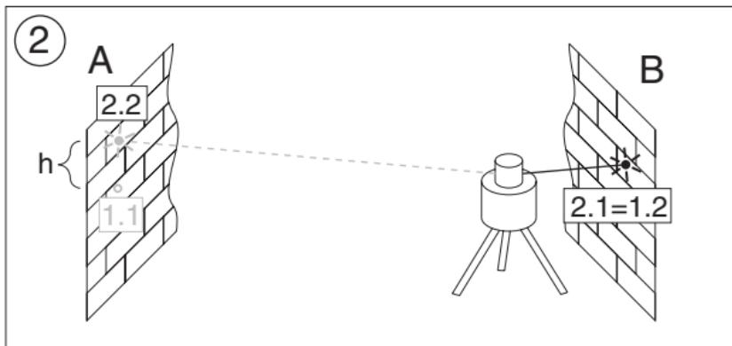
Si el aparato se encuentra en el límite de la precisión de fábrica ( $\pm 1,5 \text{ mm}$  en 10 m), a  $20 + 20 = 40 \text{ m}$ , la desviación máxima del punto cero es de 6 mm.
