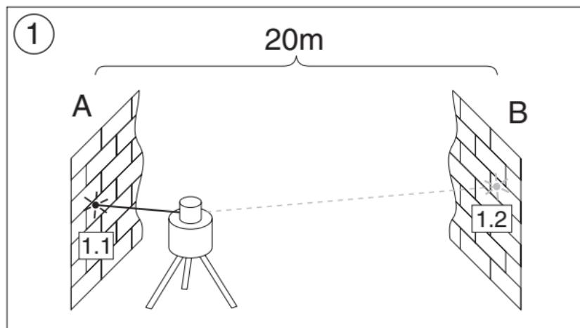
Nu placeres apparatet i nærheden af væg B. Det nivellerede apparats laserstråle rettes i X-aksens retning mod den nærmeste væg B, således at den forinden markerede højde (fra målingen på væg A) realiseres. Apparatet drejes 180°, nivelleres og strålemidten markeres på væg A. Differencen mellem de to markerede punkter udgør den faktiske apparatafvigelse.
