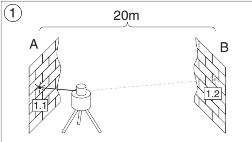
Nun plazieren Sie das Gerät nahe der Wand B. Richten Sie den Laserstrahl des nivellierten Gerätes in X-Achsen-Richtung zur nun nahen Wand B, so daß genau die zuvor markierte Höhe (aus der Messung von Wand A aus) realisiert ist. Drehen Sie das Gerät um 180°, nivellieren und markieren Sie die Strahlmitte an der Wand A. Die Differenz ( $h$ ) der beiden hier markierten Punkte ergibt nun die tatsächliche Geräteabweichung.
