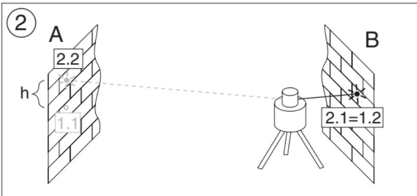
Ligt het toestel aan de grens van de fabrieksnauwkeurigheid ( $\pm 1,5 \text{ mm}$  op 10 m), dan bedraagt bij  $20 + 20 = 40 \text{ m}$  de maximale afwijking van de nulpositie 6 mm.
