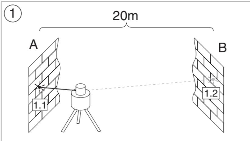
Placera nu apparaten i närheten av vägg B. Rikta den avvägda apparatens laserstråle i X-axel-riktning till den nu närlägna väggen B, så att exakt den höjd som förut markerats (utifrån mätningen från vägg A) realiseras. Vrid apparaten 180°, avväg och markera strålmitten på vägg A. Differensen mellan de båda här markerade punkterna ger nu den faktiska apparatavvikelsen.
