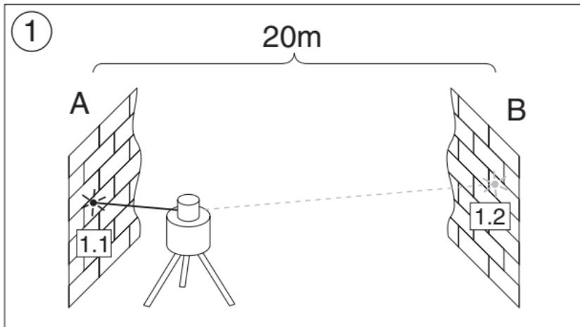
Agora coloque o aparelho perto da parede B. Dirija o raio laser do aparelho nivelado em direcção ao eixo X para a parede B próxima, de forma a que se realize exactamente a altura marcada anteriormente (na medição efectuada na parede A). Gire o aparelho a  $180^\circ$ , nivele e marque o centro do raio na parede A. A diferença de ambos os pontos aqui marcados corresponde ao desvio efectivo do aparelho.
