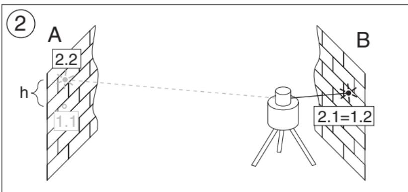
Liegt das Gerät an der Grenze der Werksgenauigkeit ( $\pm 1,5 \text{ mm auf } 10 \text{ m}$ ) beträgt bei  $20 + 20 = 40 \text{ m}$  die maximale Abweichung von der Nullage 6 mm.
