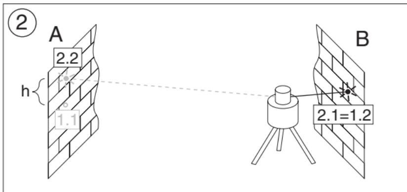
Se o aparelho estiver no limite da precisão de fábrica ( $\pm 1,5 \text{ mm}$  em 10 m) o desvio máximo da posição zero a  $20 + 20 = 40 \text{ m}$  é de 6 mm.
