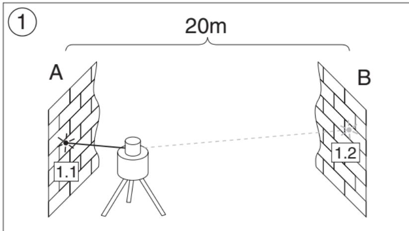
Seguidamente se coloca el aparato cerca de la pared B. Alinear el rayo láser del aparato nivelado en dirección al eje X sobre la pared próxima B, de tal forma que se alcance exactamente la altura previamente marcada (partiendo de la medición de la pared A). Girar el aparato 180°, nivelarlo y marcar el centro del haz en la pared A. La diferencia entre los dos puntos aquí marcados corresponde a la desviación efectiva del aparato.
