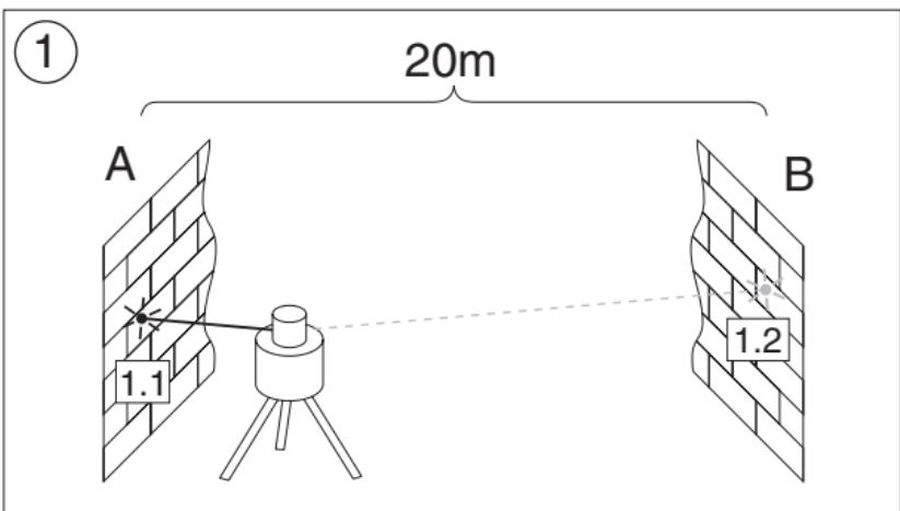
Spostare lo strumento vicino alla parete B e rivolgere l'asse X- alla stessa. Dopo l'autolivellamento, battere la quota marcando il centro del raggio laser. Ruotare lo strumento di 180° e battere una seconda quota sulla parete A. La differenza (h) tra le due quote sulla parete A indica la deviazione del raggio.
