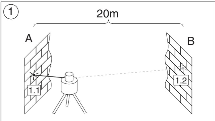
Placer désormais l'appareil près du mur B de façon à ce que le faisceau laser soit au dessus de la marque X du boîtier et que le point laser se superpose à celui marqué précédemment (lorsque l'appareil était près du mur A). Tourner l'appareil de 180° et noter la hauteur du faisceau sur le mur A plus éloigné quand le laser est ajusté. L'écart entre les deux points notés en A permet de déterminer la précision de l'appareil.
