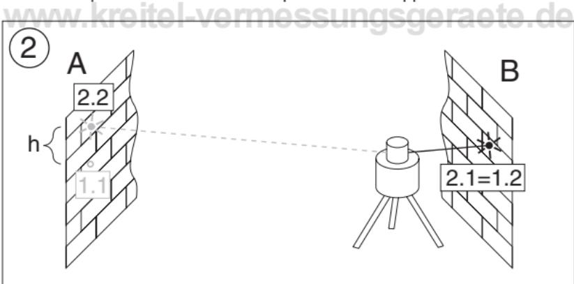
Si la précision de l'appareil est dans la zone de tolérance annoncée (+/- 1,5 mm/10 m), l'écart par rapport au point 0 sur  $2 \times 20 \text{ m} = 40 \text{ m}$  ne devrait donc pas excéder 6 mm.
