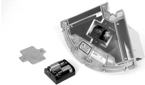
1. Drehen Sie die Schrauben gegen den Uhrzeigersinn los und nehmen Sie den Batteriefachdeckel ab.
