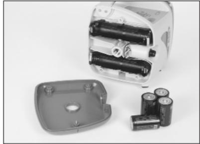
**Hinweis:** Der Laser verfügt einen Verpolungsschutz. Werden die Batterien falsch eingelegt, wird der Laser zwar nicht beschädigt, kann jedoch nicht betrieben werden. Warten Sie eine Minute, nachdem Sie die Batterien richtig eingelegt haben, bevor Sie das Gerät wieder in Betrieb nehmen.
