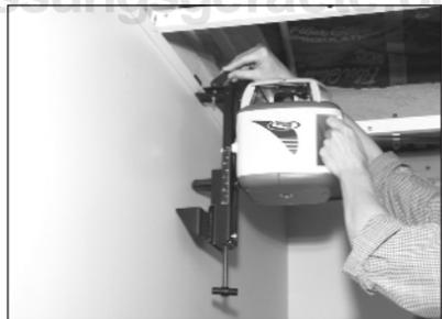
4. Drücken Sie zur Höheneinstellung den Entriegelungsknopf, schieben Sie den Laser auf die Nullmarkierung (0) der Skala (Höhe des Wandwinkels) und drehen Sie den Feststellknopf fest.
