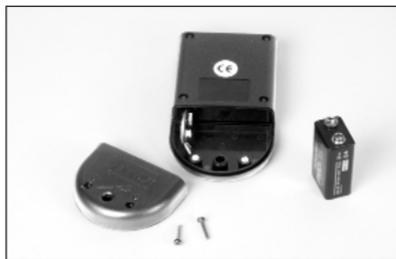
3. Setzen Sie den Batteriefachdeckel wieder an und drehen Sie die beiden Schrauben fest.
