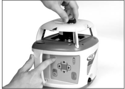
**Hinweis:** Der Laserstrahl scant im gewünschten Scanbereich. Wurde kein Scanzonenbereich festgelegt, scant der Strahl im kleinsten Bereich.
