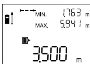
För utlösning av mätningen tryck helt ned knappen Mätning 7.
