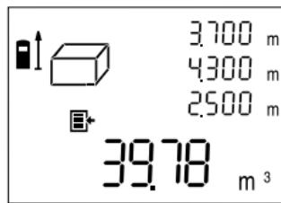
Après quoi, comme pour une mesure de longueur, mesurer l'une après l'autre, la longueur, la largeur et la hauteur. La troisième mesure effectuée, l'appareil calcule puis affiche automatiquement le résultat.
