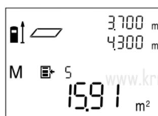
Lo strumento salva inoltre automaticamente i risultati finali delle ultime 20 misurazioni. Premendo ripetutamente il tasto per richiamo della memoria **M-/F 14** questi risultati della misurazione vengono visualizzati seguendo l'ordine inverso (per primo l'ultimo valore di misura rilevato). Sul display appare il simbolo **█**. Il contatore sul lato destro accanto al simbolo **█** visualizza la numerazione delle visualizzazioni.
