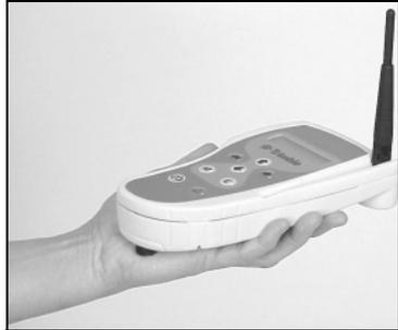
Wenn die Funkfernbedienung an einer Messlatte befestigt und vertikal ausgerichtet ist, sollte die Antenne von der Oberseite der Funkfernbedienung nach oben ragen.
