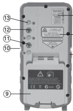
9. Batteriefach mit Verschluss (für 4 AA-Batterien)
