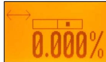
**Fluchtungsmodus** – Bewegt den Laserstrahl vertikal bis zum oberen Anschlag, um die Richtung am ersten Tag ohne einen SF803 einstellen zu können.
