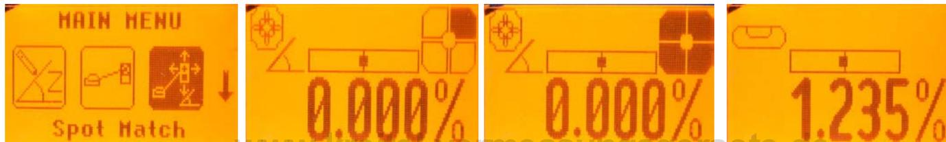
**Automatisches SpotLok (nur DG813)** – Automatisches SpotLok (ähnlich PlaneLok) dient zum Ausrichten und Fixieren des Strahls am Mittelpunkt des SF803 (im automatischen oder manuellen Modus).
