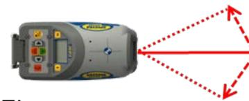
Drücken Sie in der Standardanzeige kurz die Taste **M** und wählen Sie den Eintrag **Li/Re-> Mitteln** mithilfe der **Tasten (+)/(-)** und **Links/Rechts**.
