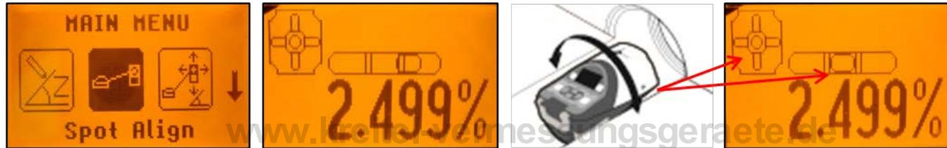
Drücken Sie die Taste **E** **nochmal**, um die automatische Fluchtung zu starten. Der Strahl wird als Fächerstrahl abgestrahlt und sucht automatisch im Bereich bis +45° nach der Mitte des SF803.
