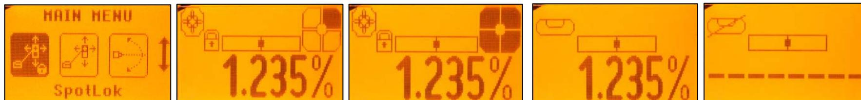
**Manuelle Strahlsuche (nur DG813)** – Die Strahlsuche dient zum Verlegen von Rohrleitungen bei manueller Strahlerkennung mit dem **Spot Finder SF803**; sie kann im **automatischen und im manuellen Modus** aktiviert werden.
