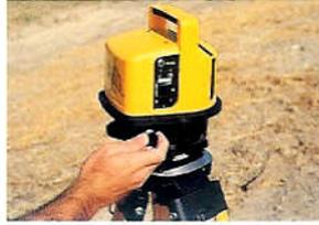
Wenn der PlumbPlane™ ausgerichtet ist, produziert er eine selbstkontrollierte, vertikale Lichtebene. Mit dem Empfänger 1175XL können jetzt zwischen Start- und Zielpunkt alle Ausricht- und Markierungsarbeiten durchgeführt werden.
