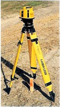
Der PlumbPlane™ ist schnell über dem Kontrollpunkt (Startpunkt) aufgestellt und auf den am Zielpunkt aufgestellten Empfänger 1175XL mit Lichtanzeige 1179 ausgerichtet.
