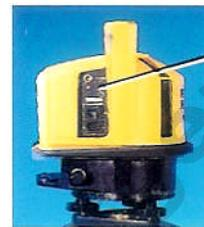
Ist die vertikale Lichtebene ausserhalb des Toleranzbereiches, blinkt die Kontrollleuchte und das Gerät schaltet ab.
