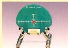
Hohe Genauigkeit. Mit 2 mW Ausgangsleistung hat der Laserstrahl eine große Reichweite und ist auf der Zieltafel auch bei Tageslicht gut sichtbar.
