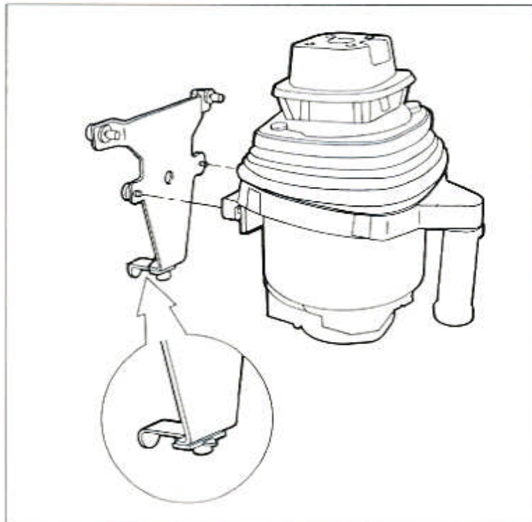
Abnehmbare Justierplatte für horizontalen Einsatz anschrauben.
