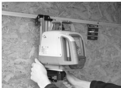
Die Kante befindet sich an der Nullmarke (0) auf der Skala (Höhe der Wandleiste), und drehen Sie den Feststellknopf, um ihn festzuziehen.
