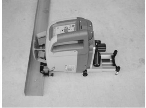
**Hinweis:** Wenn Sie den Senkrechtstrahl zur Ausrichtung verwenden, aktivieren Sie im Menü RC1402 die Funktion Strahleneintauchen, um den Senkrechtstrahl zur Kontrollmarkierung für die entfernte Wand zu bewegen.
