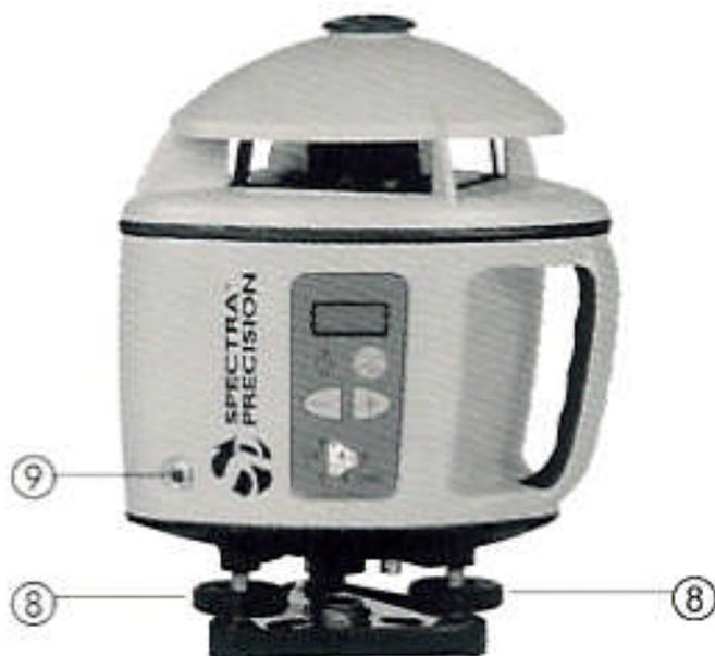
⑧ Fußschrauben für Nivellierung: Zur groben Vornivellierung und Neigungseinstellung.
